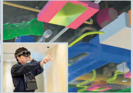
ホロレンズを用いた天井内の配管チェック
