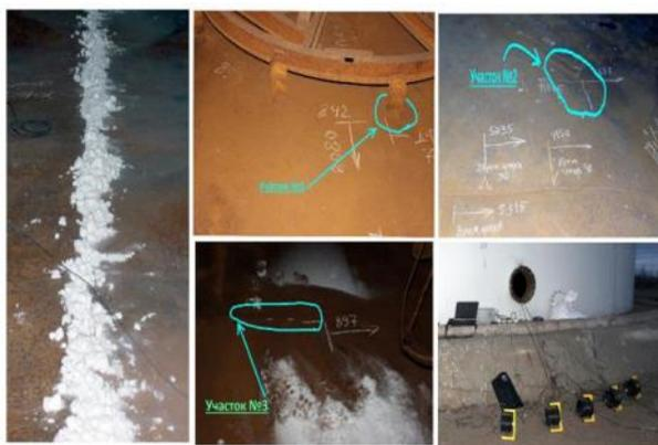
Рис. 6. Обнаруженные источники АЭ при локальном низкотемпературном нагружении днища резервуара.
