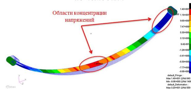
Рис. 5. НДС рессоры автомобиля. Напряжения вдоль оси X
