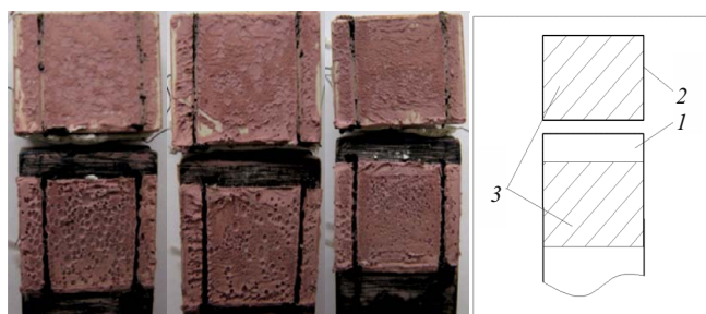
Рис. 3. Вид образцов КС после испытаний: 1 — металлическая пластина; 2 — керамическая призма; 3 — место склейки
