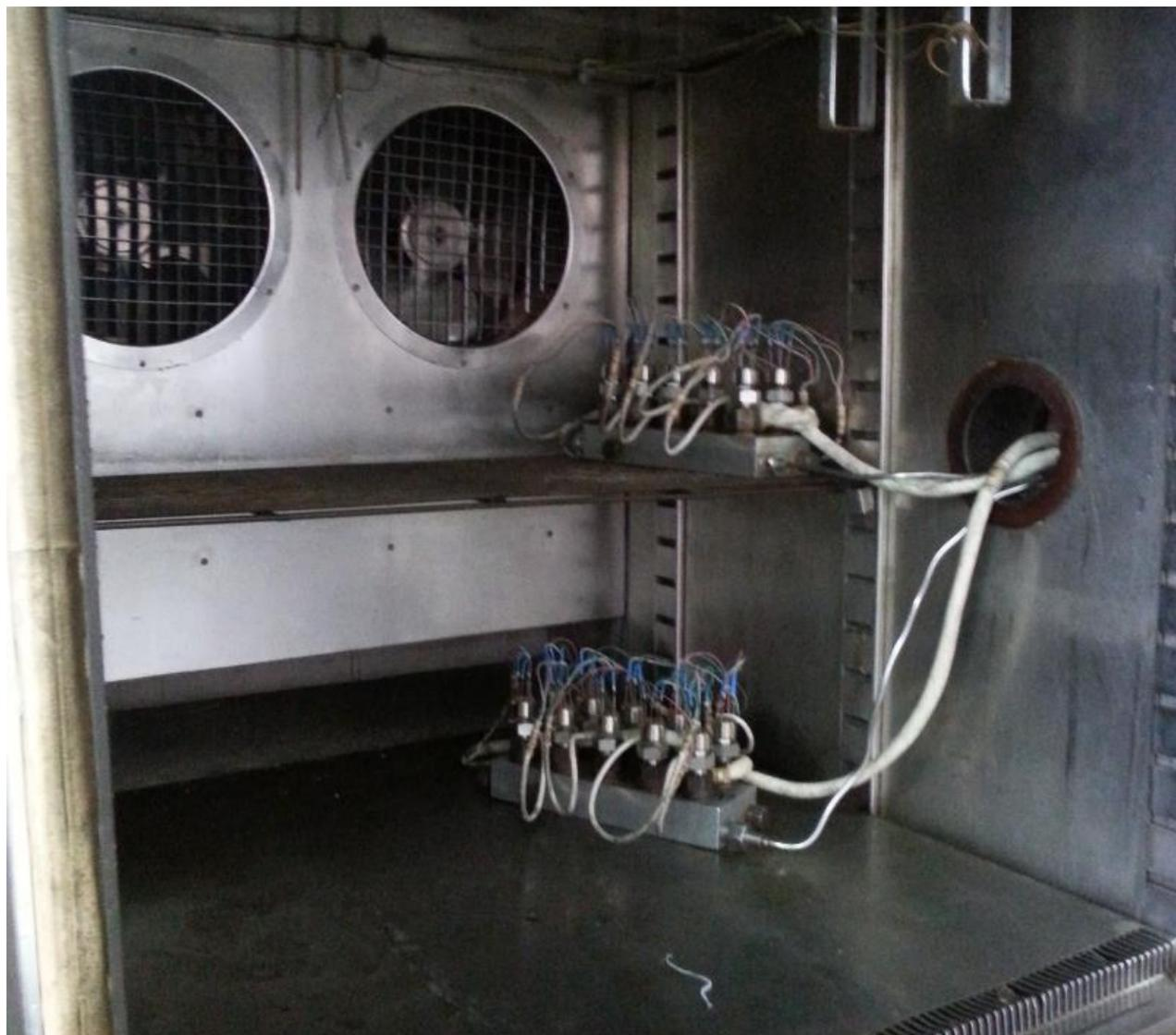
Рис.6.5. Испытание датчиков в камере тепла(холода)
