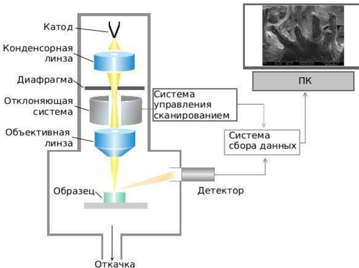
Рис.3.2. Конструкция СЭМ
