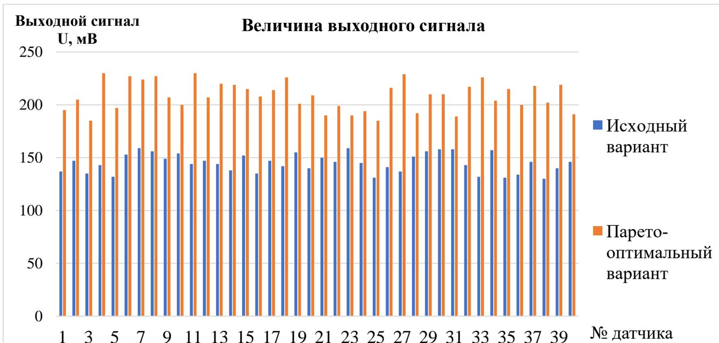
Рис.6.4. Сравнительный анализ по величине выходного сигнала серийно-выпускаемого и полученного в ходе оптимизационного расчета датчиков давления
