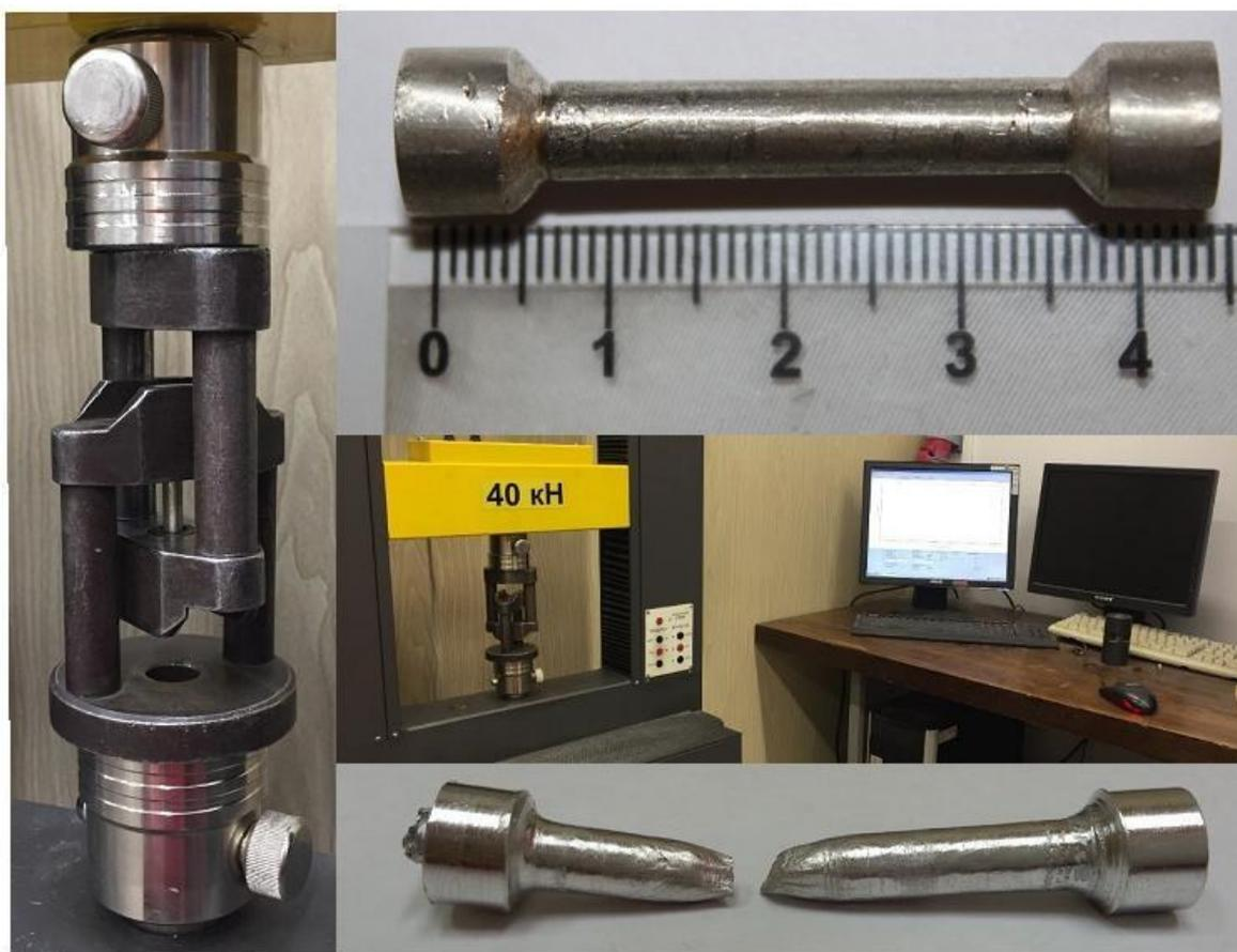
Рис.3.13. Исходный образец, разрывная машина МИ-40КУ, образец после разрушения
