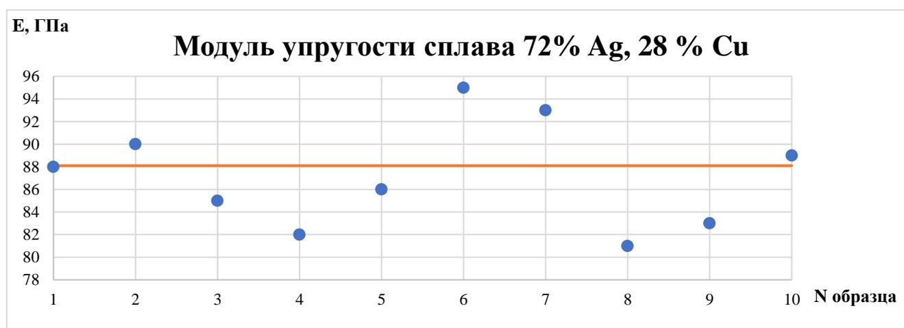
Рис.3.15. Результат определения модуля упругости образца из сплава 72% Ag, 28% Cu
