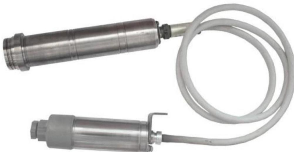
Рис. 1.13. Датчик с отдельным электронным блоком
