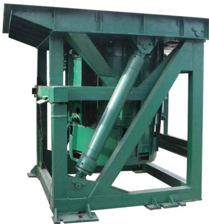
Рисунок 8. Типичная конструкция индукционной печи типа ИЧТ
