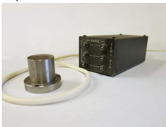
Рисунок 8. “Формирующий” электронный преобразователь и трёхосевой вибродатчик с косоугольным базисом.
