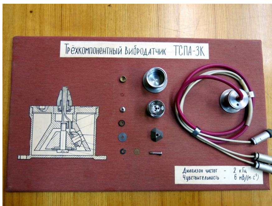
Рисунок 23. Внешний вид и детализировка ТОДВ типа ТСПА-3К
