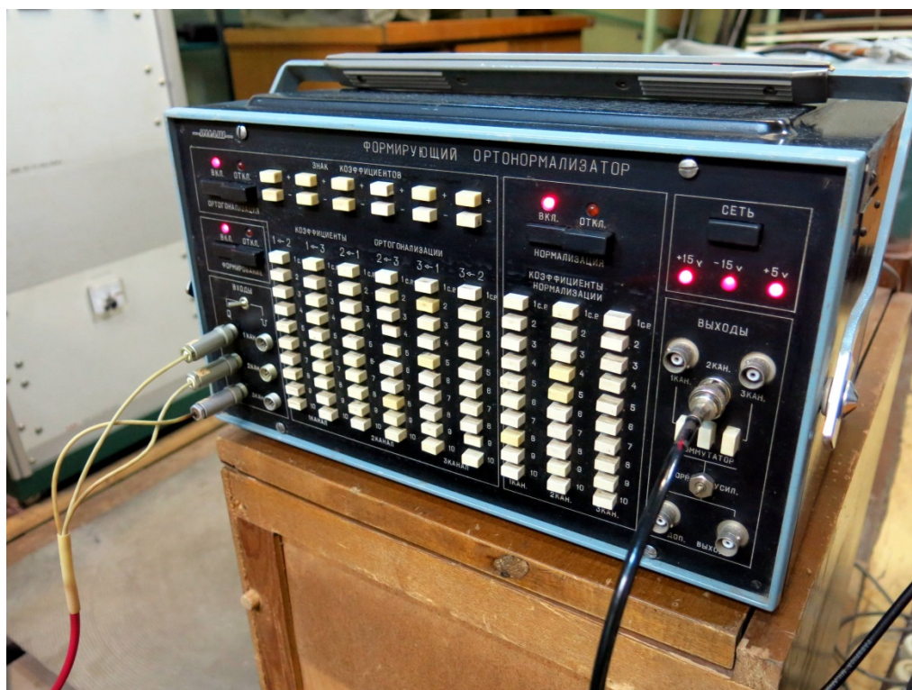
Рисунок 32. Аналого-цифровой формирующий ортонормализатор-усилитель заряда, с помощью которого проводились исследования коэффициентов матриц чувствительности ТОДВ
