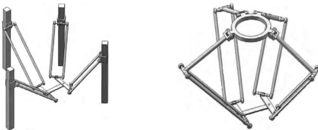
Рисунок 1.26 Симметричный манипулятор Н4 с призматическими и вращательными соединениями [151].
