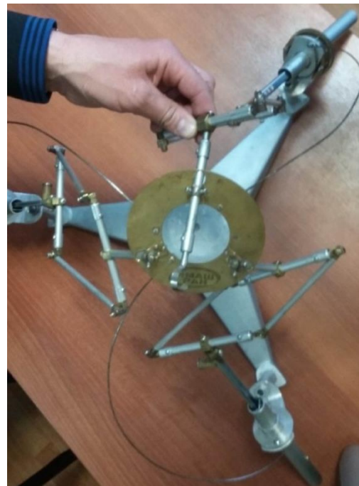
Рисунок 5.18. Положение механизма, близкого к особому.
