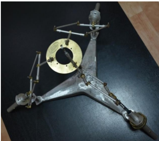
Рисунок 5.11. Крайнее положения выходного звена в рабочей зоне.
