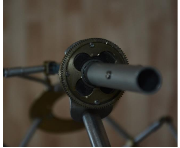
Рисунок 5.5. Зубчатая передача для передачи вращения на рабочий орган. Вид сверху.
