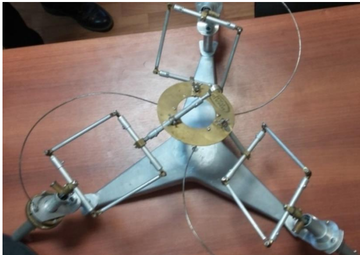
Рисунок 5.10. Уравнивание сил веса подвижных частей механизма с помощью изгибных упругих элементов.
