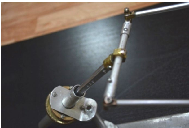
Рисунок 5.7. Механизм шарнирного параллелограмма.
