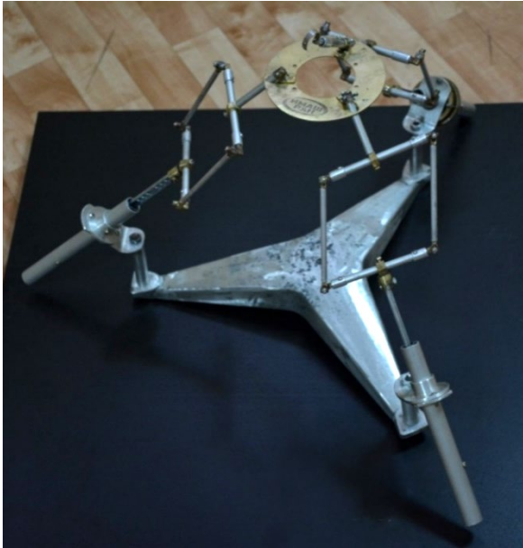
Рисунок 5.1. Общий вид механизма с четырьмя степенями свободы.
