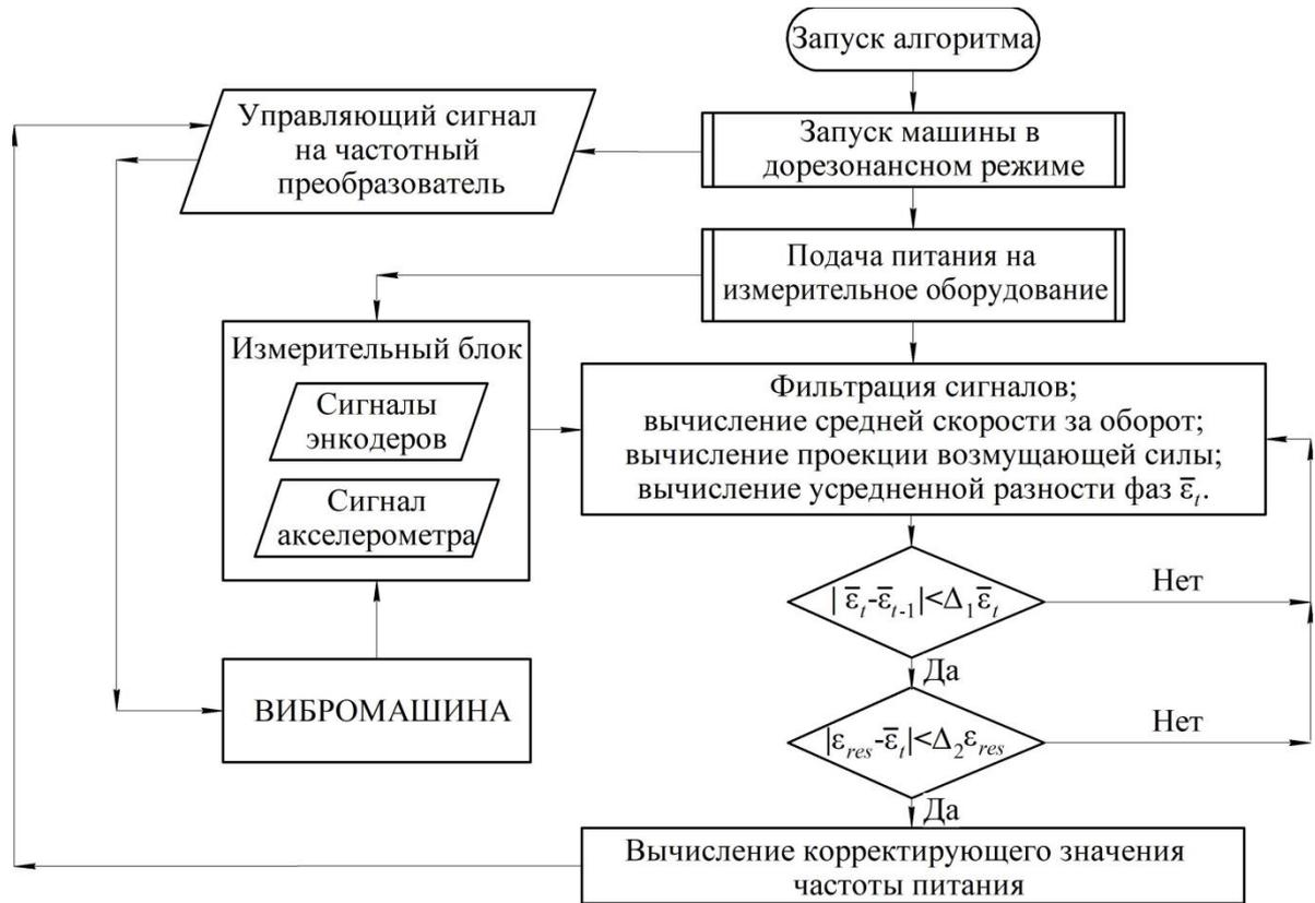
Рисунок 3 – Алгоритм настройки и поддержания резонансного режима.
