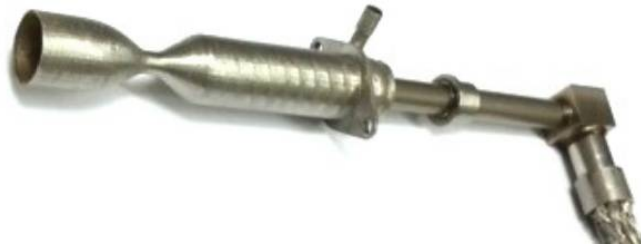
Рисунок 4.12 – Внешний вид ЭТМД с автономным нагревательным элементом (процитировано по [141])
