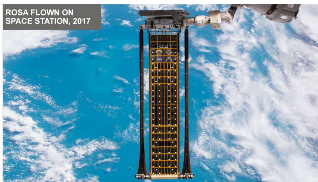
Рисунок 1.1 – ПСБ ROSA в развёрнутом состоянии в составе МКС (надпись на рисунке: Полёт ROSA на МКС, 2017)
