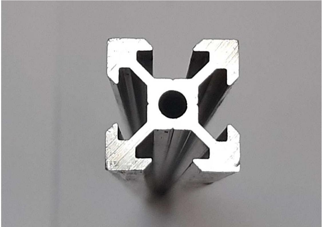
Рисунок 4.2. Профиль неподвижного основания
