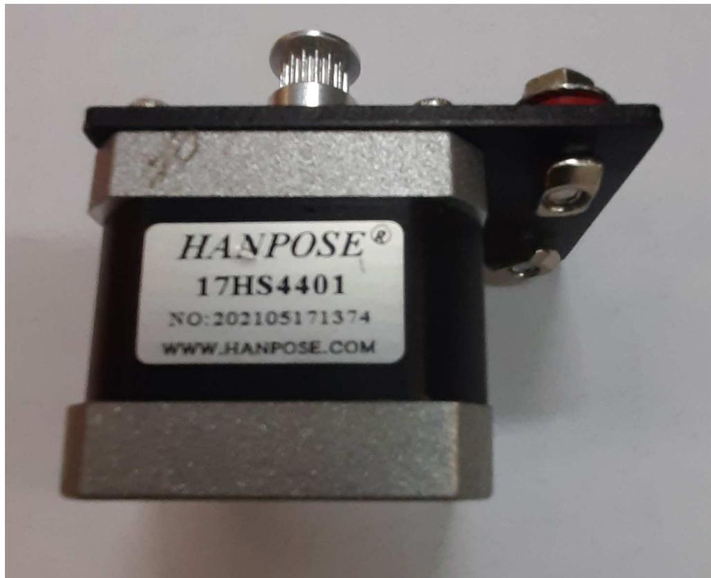
Рисунок 4.5. Шаговый двигатель на неподвижном основании
