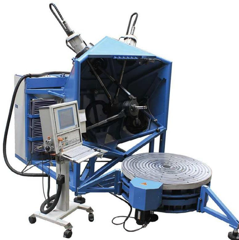
Рисунок 1.7 – Мобильный портативный станок МЕТРОМ
