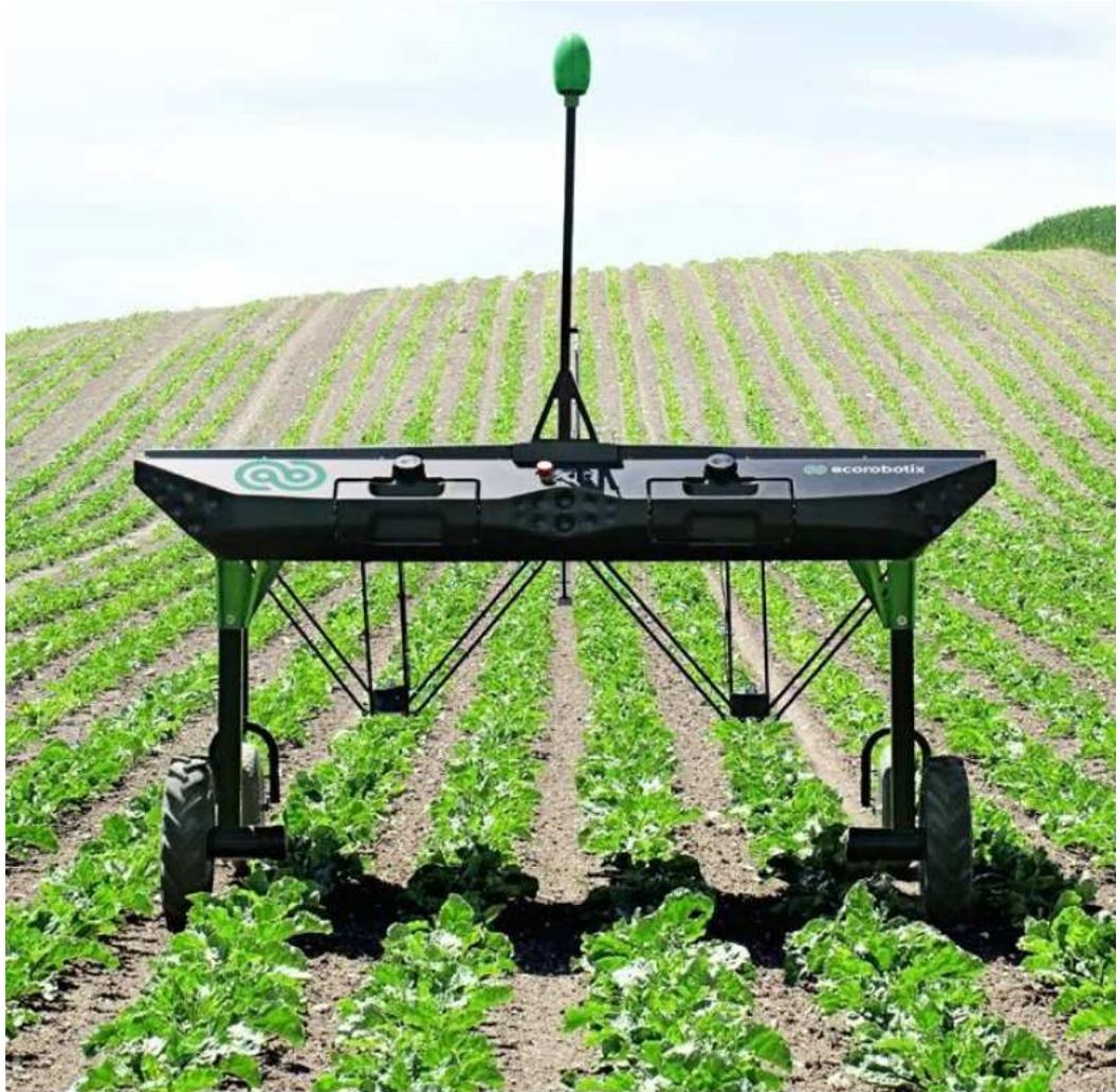
Рисунок 1.10 – Сельскохозяйственный робот на базе механизма дельта «ecoRobotix SA»
