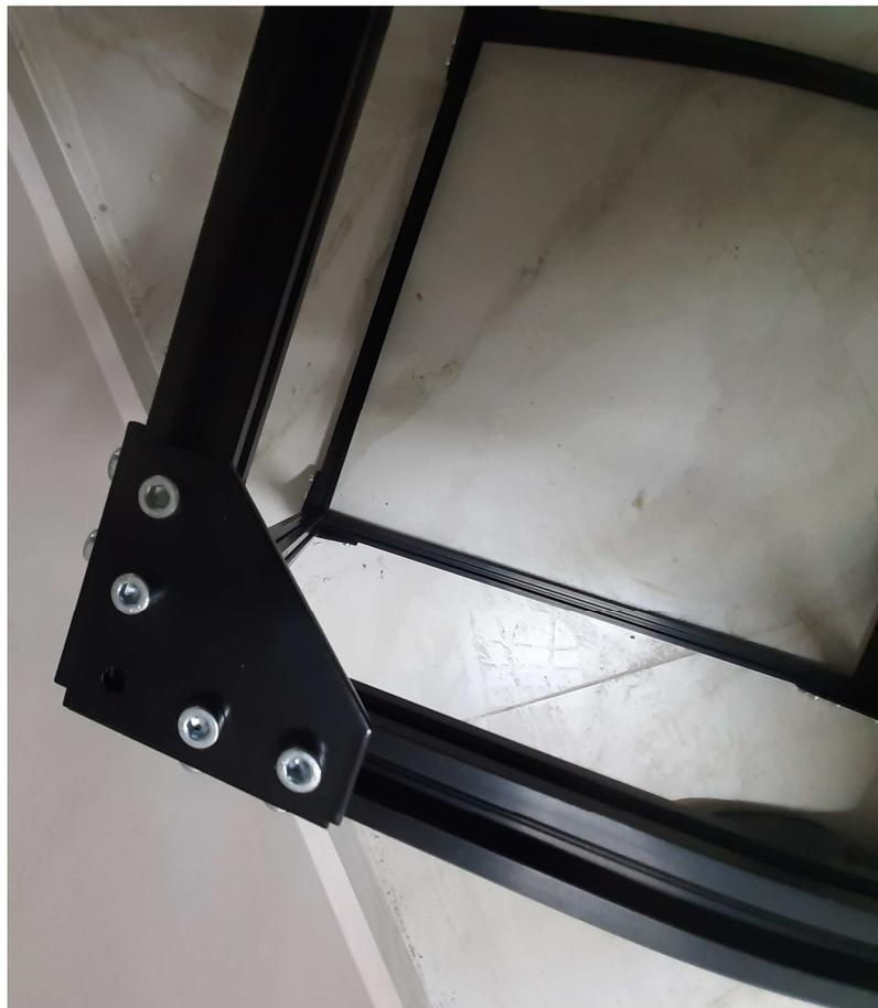
Рисунок 4.3. Пластины для сборки неподвижного основания
