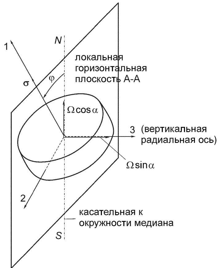
Рис. 7.15(b). Ось симметрии и собственного вращения 1 движется в локальной горизонтальной плоскости.
