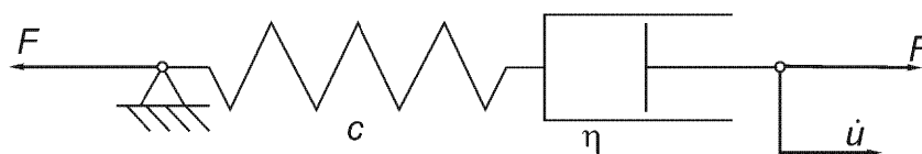
Рис. 4.9. Схематическая одномерная модель тела Максвелла: Пружина и демпфер при последовательном соединении.
