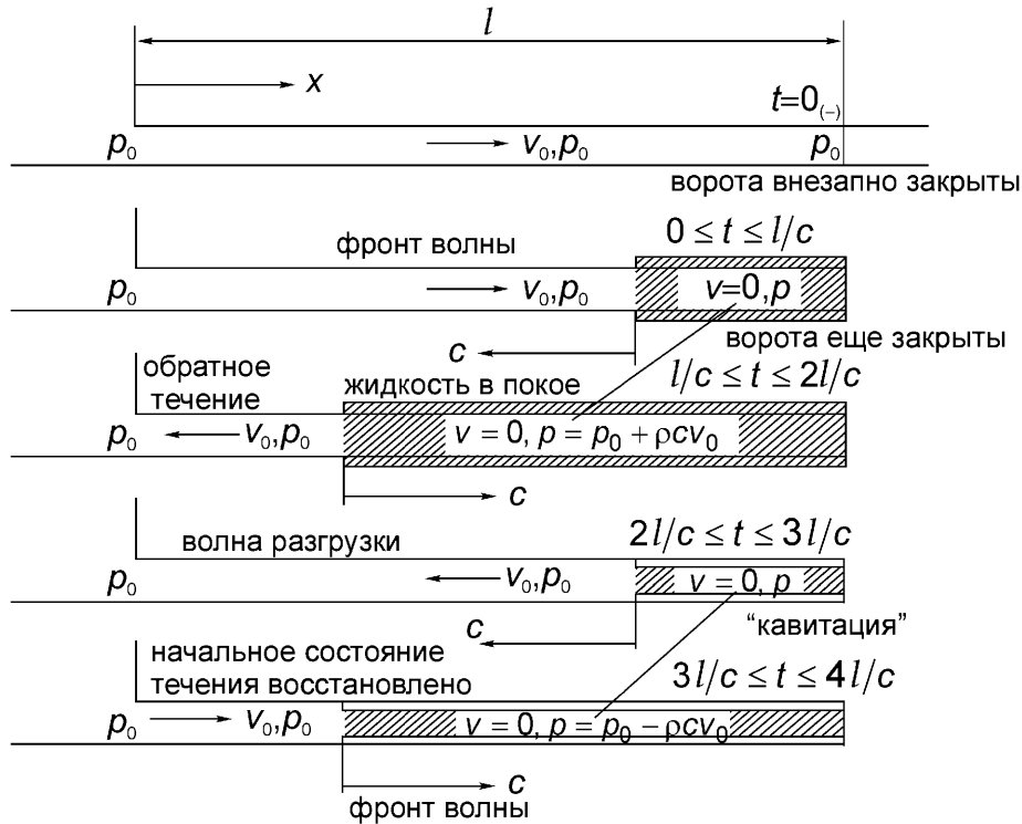
Рис. 12.11. Внезапное перекрытие трубы. Волны распространяются без учета диссипации и дисперсии. Учитываются линейно упругая квазистатическая деформация трубы и линейная сжимаемость жидкости.
