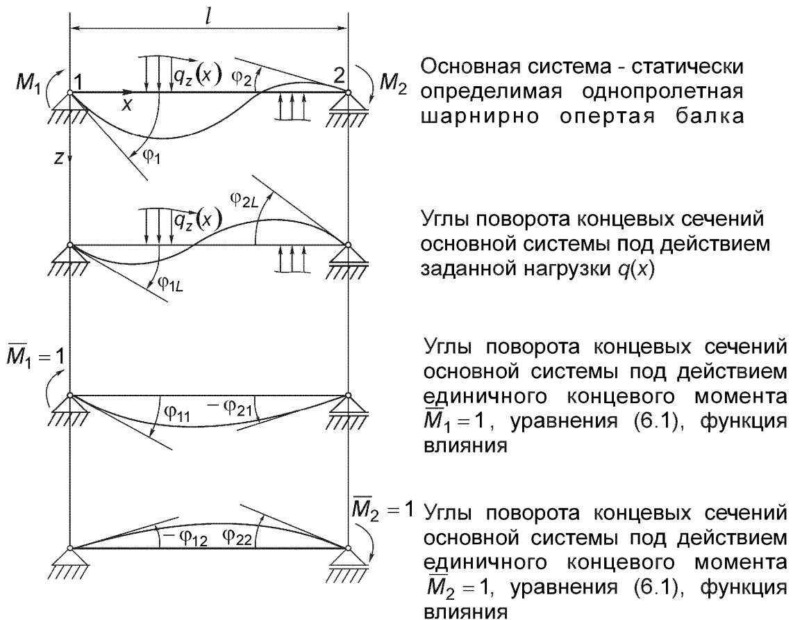
Рис. 6.21. Деформации однопролетной шарнирно опертой балки, представляющей собой статически определимую систему, ассоциированную с неразрезной балкой на многочисленных опорах; см. также рис. 6.13. Метод сил.
