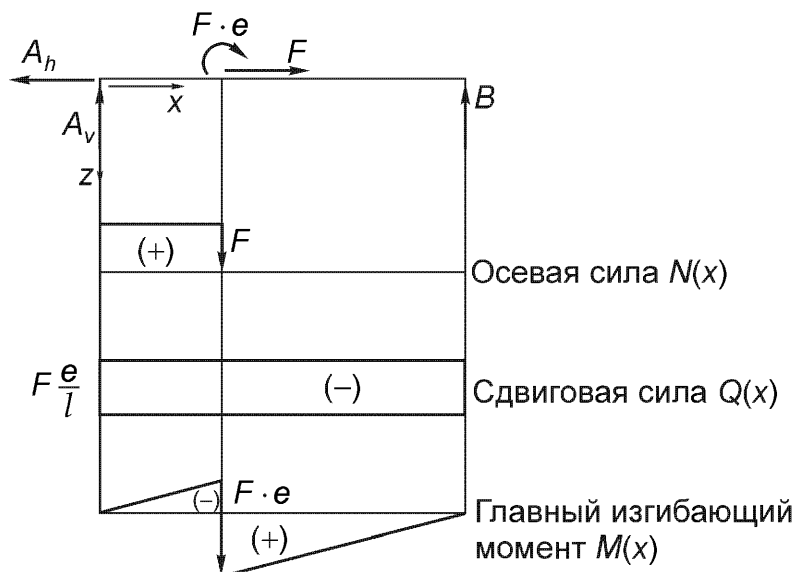
Рис. 2.39. Нагруженная балка, статически эквивалентная балке, изображенной на рис. 2.38, Диаграмма постоянного сдвигового усилия и изгибающего момента со скачком.
