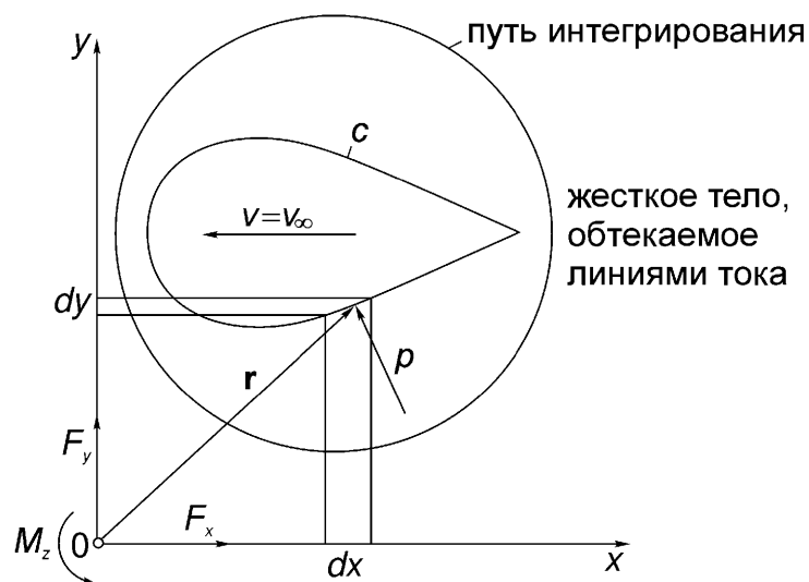
Рис. 13.14. Давление, действующее на твердое тело, движущееся поступательно и равномерно в идеальной жидкости.
