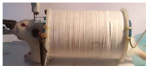
Рис 1. Экспериментальная установка для облучения крысы СНМП с одновременной регистрацией мозгового кровотока.. Стрелкой показано расстояние от датчика для регистрации мозгового кровотока до края соленоида (20 мм). Магнитная индукция около датчика составляла 0.73 Гаусса
