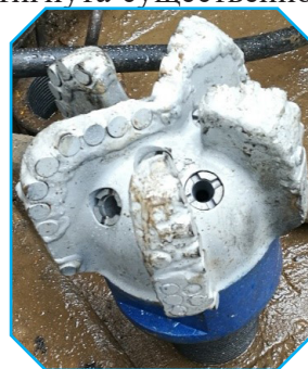
Общий вид долота с установленными волновыми генераторами
