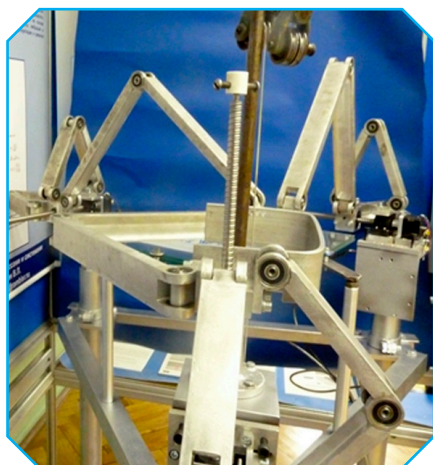
Механизм со стабилизирующими звеньями
