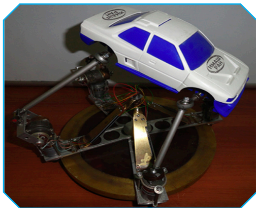
Макет тренажера для подготовки водителей
