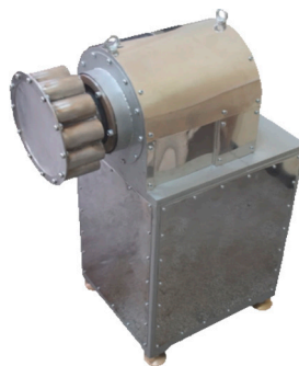
Установка для волновой обработки жидких и сыпучих сред
