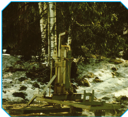
Разрушение взрывогенератором бетонной плиты серией последовательных взрывов
