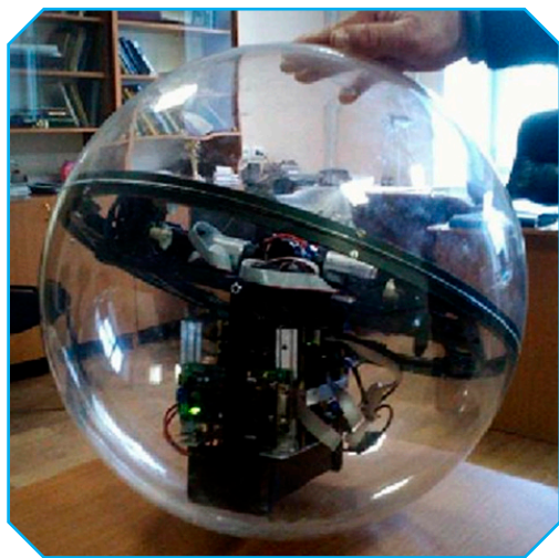
Сферобот – мобильный робот-шар
