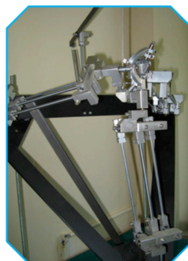
Манипулятор с карданными шарнирами и дополнительными тягами
