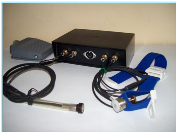
Общий вид аппаратно-программного комплекса для анализа пульсовых волн в сосудах
