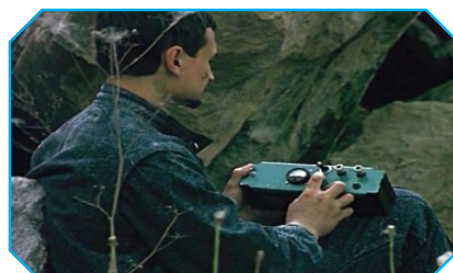
Зарядка конденсаторов БЭИ-7А и выбор частоты инициирования кассет с ДПУ-1
