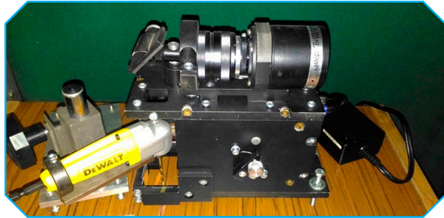
Специализированный мобильный спекл-интерферометр для экспериментального исследования НДС и определения остаточных напряжений в натурных условиях
