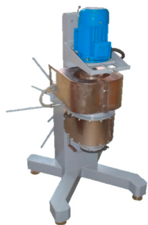
Установка для волновой обработки вязких и высоковязких сред в порционном режиме
