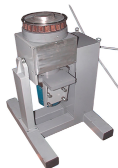
Роторно-волновой измельчитель сыпучих материалов
