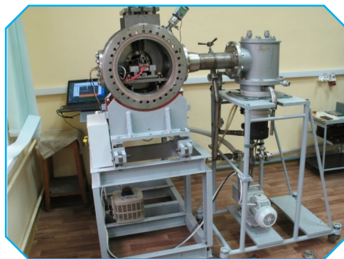
Внешний вид стенда для испытаний в условиях, имитирующих космос
