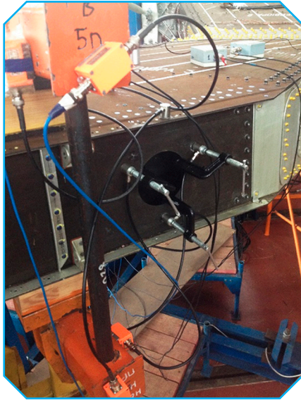
Исследование кинетики повреждений в зоне технологического окна стенки лонжерона акустико-эмиссионным методом
