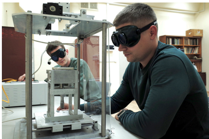
Сотрудники отдела сплавляют порошок имитатора лунного реголита на лабораторной лазерной установке
