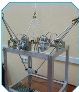
Манипулятор для испытаний моделей летательных аппаратов в аэродинамической трубе
