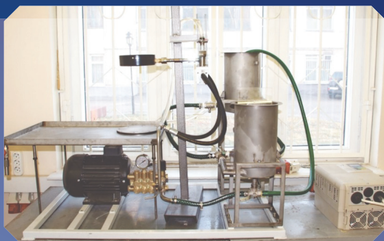
Экспериментальный стенд по исследованию процессов перемешивания в волновых проточных кавитационных генераторах.
