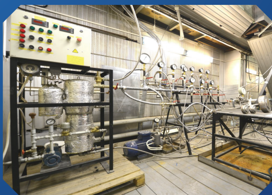
Экспериментальный стенд по исследованию возможностей применения волновых процессов с целью предотвращения и очистки отложений в трубопроводах.
