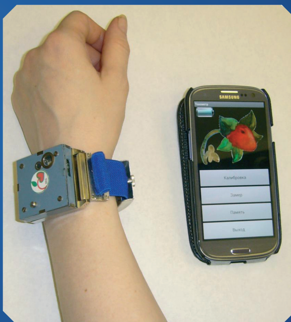
Устройство для измерения и беспроводной передачи сигнала пульсовой волны
