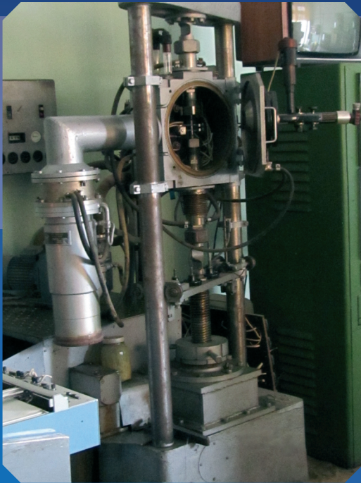
Установка для малоцикловых испытаний при высокотемпературном нагреве в вакууме
