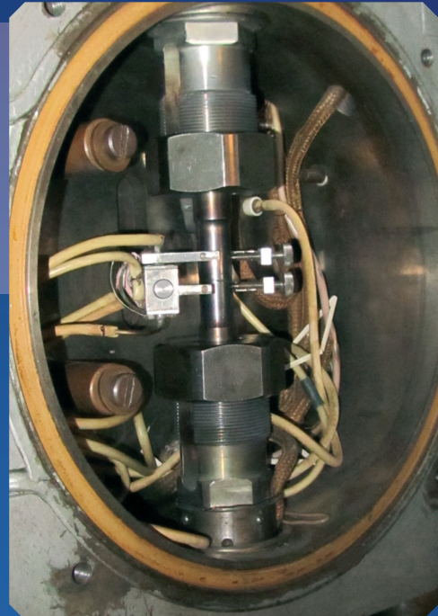
Вакуумная камера к установке для малоцикловых испытаний на растяжение-сжатие
