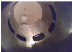
Рис.4. Задир продольных гидроцилиндров культиватора навесного КПС-4
