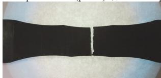
Рис. 1. Разрушенный образец из однонаправленного слоистого углепластика проводилось с постоянной скоростью перемещения активного захвата 10 мкм/сек (рис. 2). Для однона-
