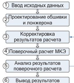
Рис.1. Блок-схема алгоритма проектирования элементов лонжеронного крыла малого удлинения
