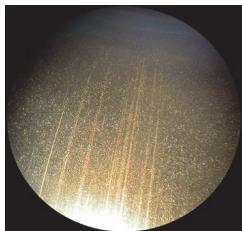
Рис.2. Риски на внутренней поверхности цилиндра погрузчика на тракторе МТЗ
