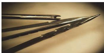
Рис. 1. Иглы для предварительной обработки преформы
