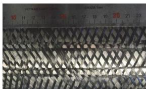
Рис. 1. Пример структуры, изготовленной плетением.
