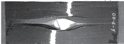
Рис. 2. Разрушение пластины из ФГМ при одноосном растяжении [3].
