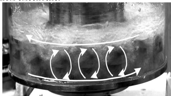
Рисунок 2. Один из режимов перемешивания в лабораторном волновом смесителе (стрелками указаны осреднённые направления течения жидкости).
