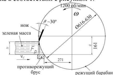
Рис. 1. Схема работы режущего барабана комбайна
