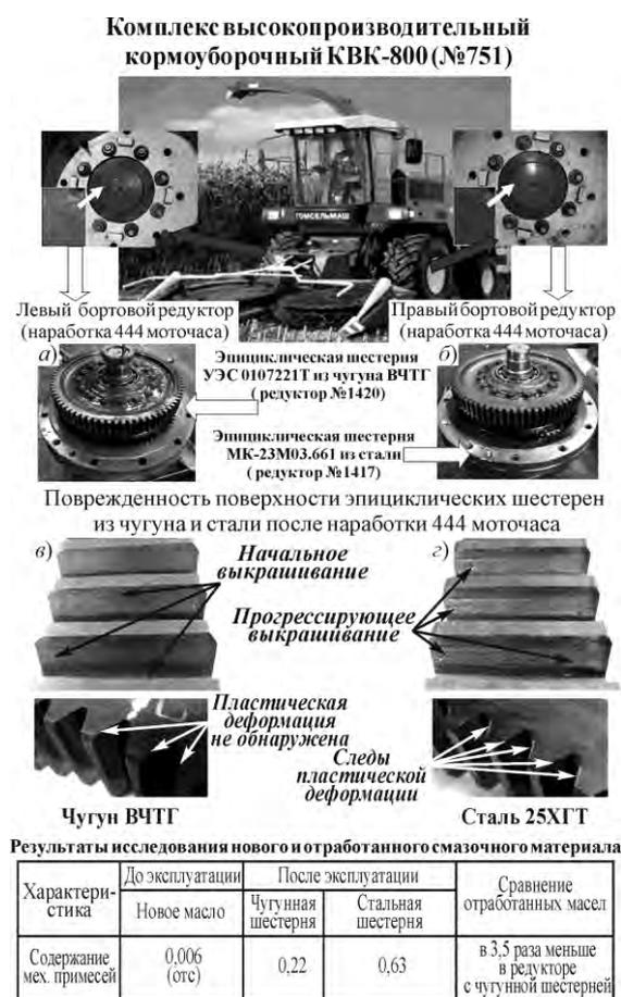
Рис. 1. Общий вид комбайна КВК 800 (№751) и эксплуатационные повреждения зубьев колес из чугуна (а, в) и стали (б, з)
