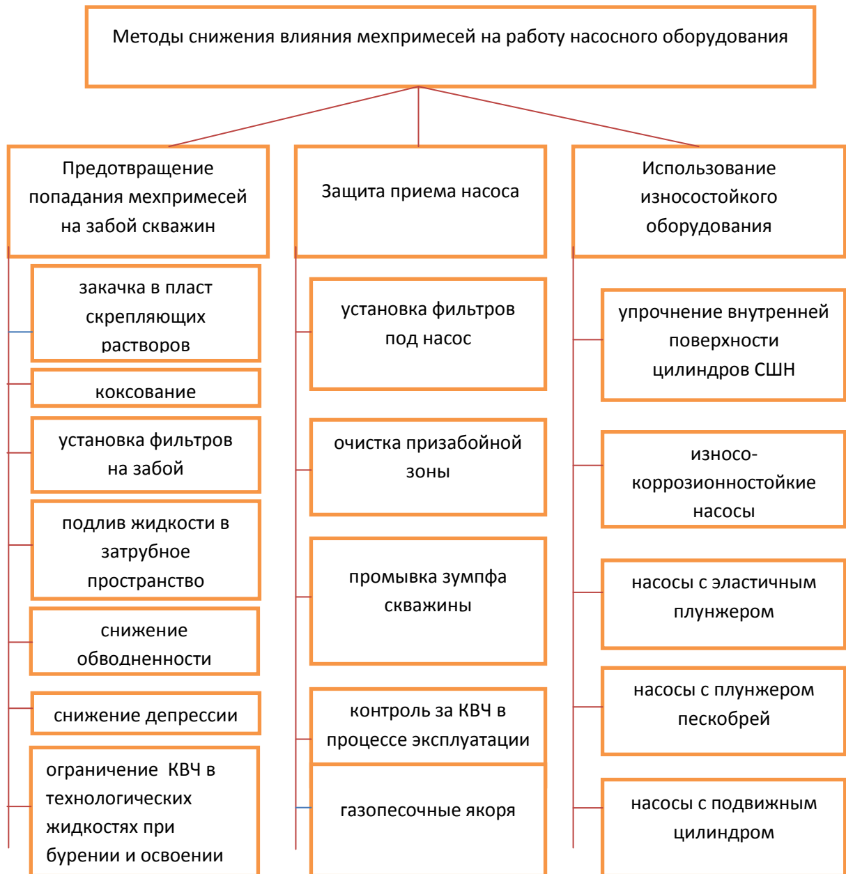
Рисунок 5 - Структурная схема методов защиты внутрискважинного оборудования от механических примесей
