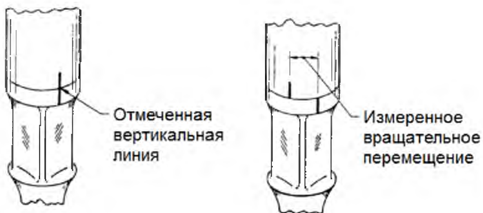
Рисунок 1.14 - Метод контроля свинчивания с натягом
