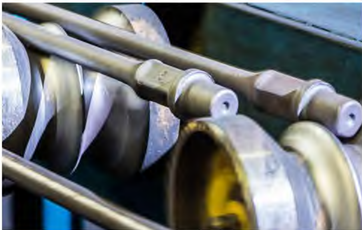
Рисунок 1.12 - Дробеструйная обработка насосной штанги
