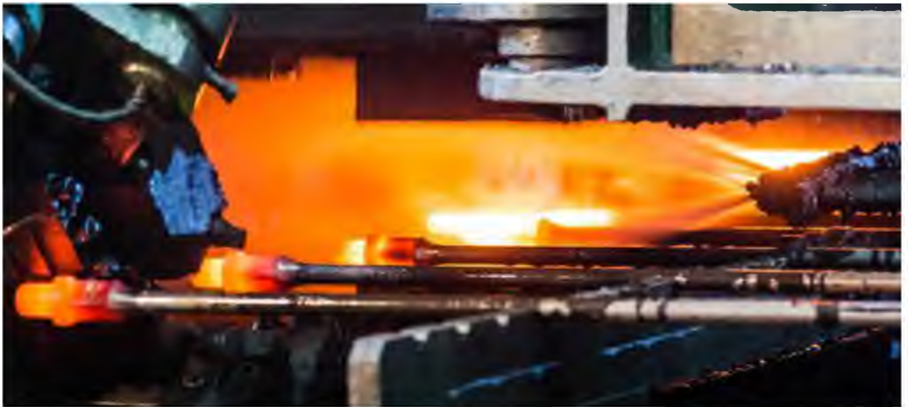
Рисунок 1.8 - Ковка насосных штанг
