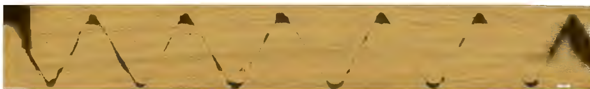
Рисунок 4.4. – Снимок конической резьбы после её нагружения
