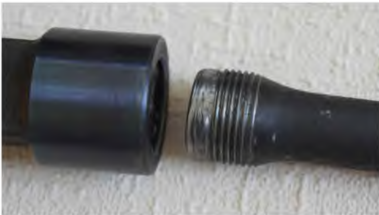
Рисунок 4.3 – Укрупнённый вид резьбового соединения.
