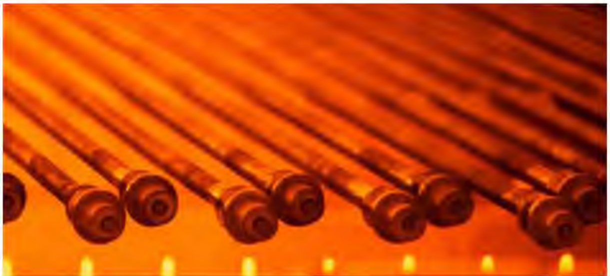
Рисунок 1.10 - Заготовки насосных штанг послековки
