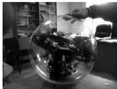
Рис.2. Сфероробот SphEROB.
